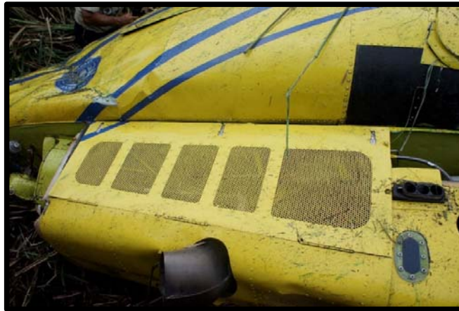
Fotografía No. 7 Daños en el fuselaje.
