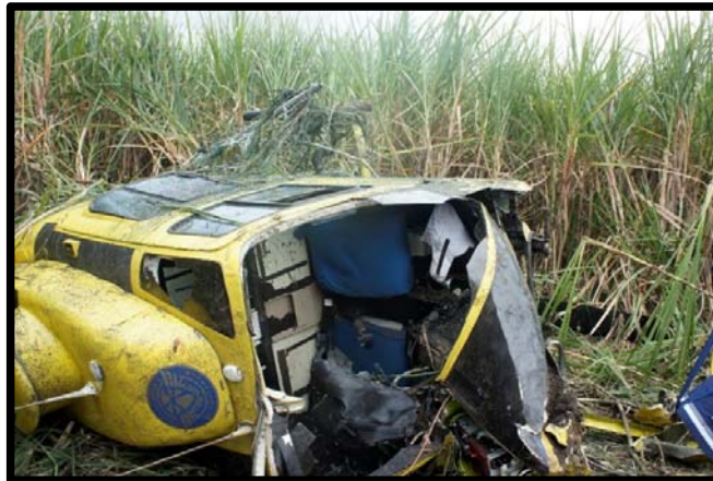
Fotografía No. 4 Daños parte frontal.
